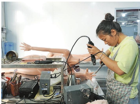
矽胶娃娃浇灌原料、脱模成型后，女工打磨娃娃肢体细节。（沈燕媚摄）
