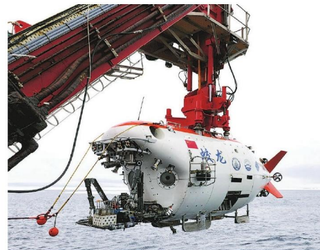
「蛟龙」号被母船吊起回收。为了这次北极任务，「蛟龙」进行抗寒改造并添加导航、定位设备。（新华社）
