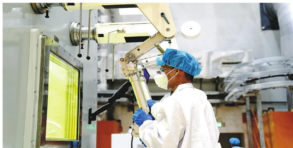
中国建成的钍基熔盐实验堆近日首次实现钍铀核燃料转换，证明熔盐堆核能系统利用钍资源的技术可行性。图为科研人员在实验堆加料-取样热室工作。
