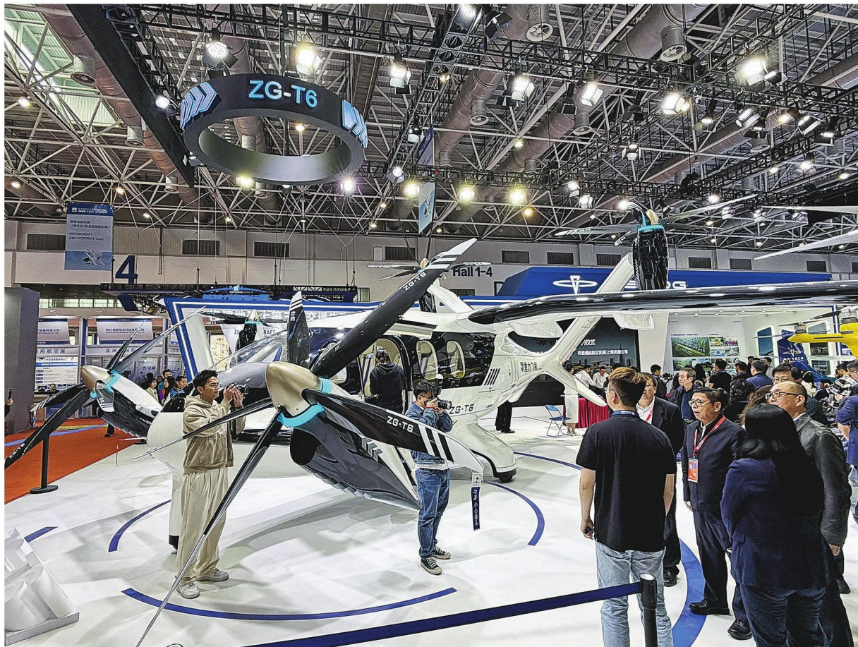
零重力 ZG-T6 纯电动倾转旋翼 eVTOL 日前亮相珠海航展，引起多人围观。该机续航里程 300 公里，巡航速度达 250 公里时速，可搭载 6 人。（刘晓宇摄）
